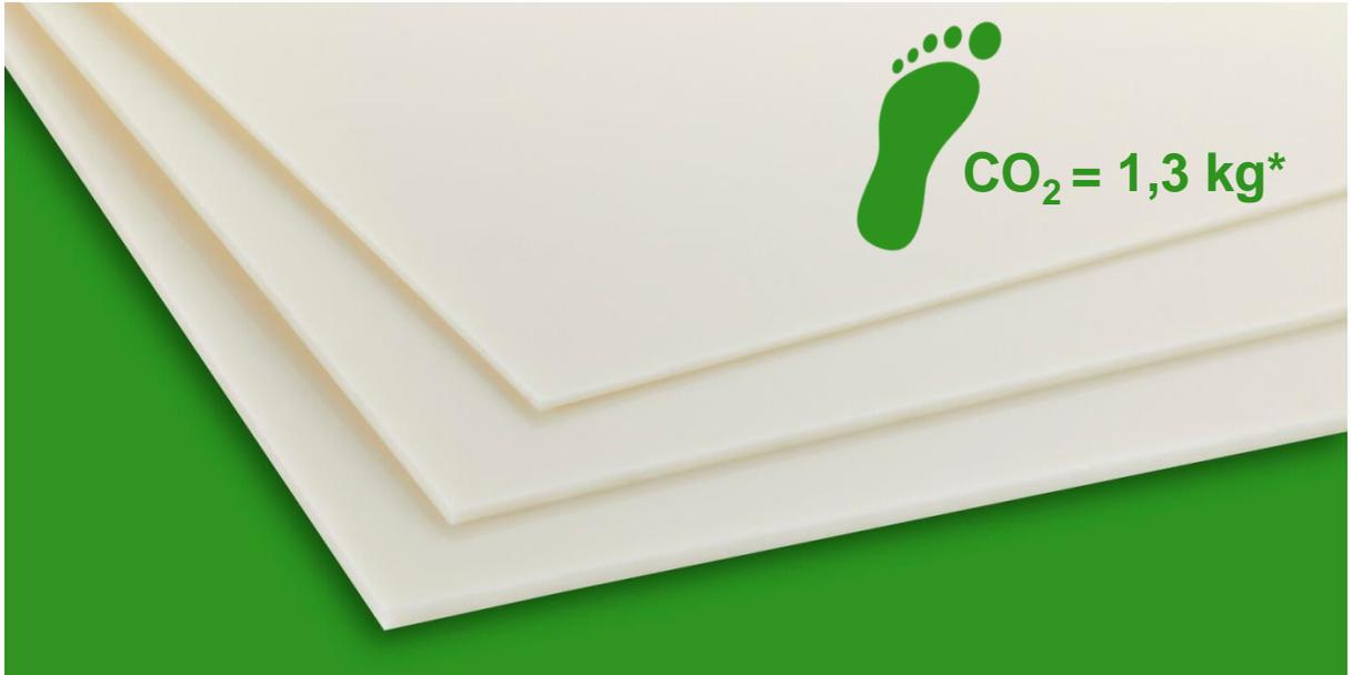
**ECO-GEHR PLA-HI<sup>®</sup>** Platten auf Basis nachwachsender Rohstoffe bestehen zu 90% aus PLA. Sie werden wie alle GEHR-Produkte CO<sub>2</sub>-neutral nach GHG Scope 1+2 produziert. Die Platten zeichnen sich durch eine hohe Schlagzähigkeit aus und sind somit für anspruchsvolle Anwendungen geeignet. Die Tafeln können sehr gut mechanisch verarbeitet werden. Möglich ist in der Nachbearbeitung z.B.
