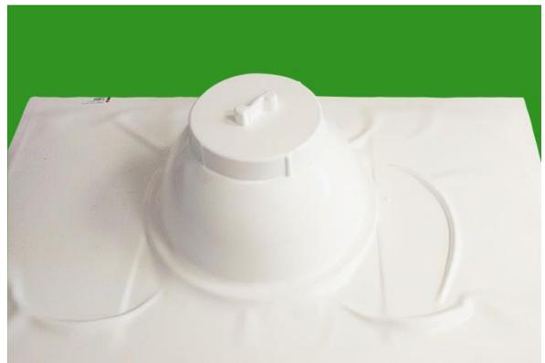
ECO-GEHR PLA-HI<sup>®</sup> Platten können sehr gut mechanisch verarbeitet werden, z.B. Stanzen (links) oder Tiefziehen (rechts)
